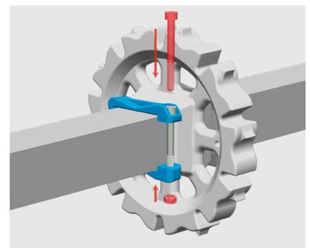
**3** La fixation par boulon et écrou du clip assure un serrage fiable à faible coût.
