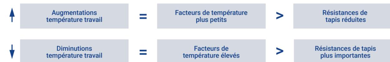
Il convient également de noter qu'à des températures plus basses, la surface de la bande devient plus cassante. Il s'agit d'un facteur important à prendre en compte dans le cas d'applications avec impact.
