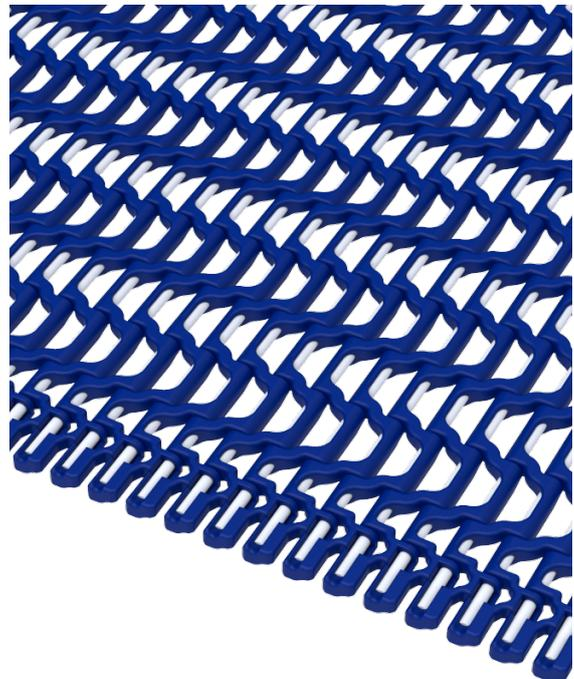
Avec un pas de 12 mm et une surface ouverte de 43 %, la nouvelle série Eurobelt F12 est idéale pour les applications où il est nécessaire d'effectuer de très petits transferts dans des applications nécessitant une grande surface ouverte et une grande propreté, telles que les lignes de refroidissement, les entrées et sorties de four, etc
