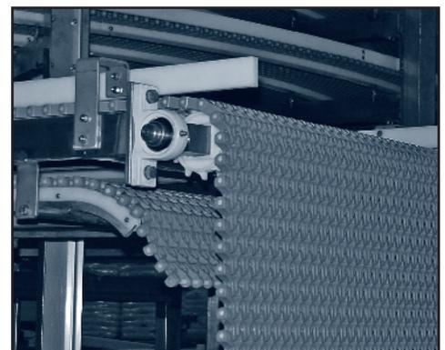
También ofrecemos engranajes para utilizar con Mototambor en aplicaciones en las que se necesita una especial limpieza o para transportadores en los que exista una imposibilidad de colocar el motor externamente por problemas de espacio o seguridad.
