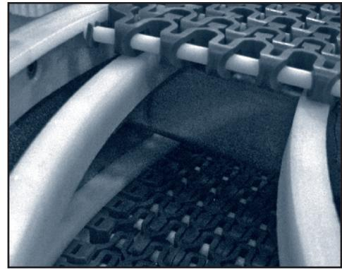
Los perfiles de sujeción no deberán estar en contacto con la banda (ver figuras inferiores):
