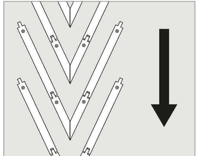
Les bandes de glissement sont placées sur la longueur et largeur du convoyeur selon le dessin ci-dessus.
