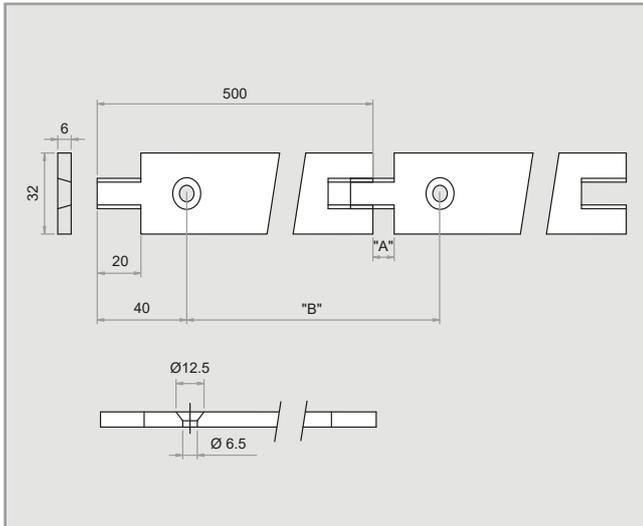
Les glissières plates ont un système de fixation avec des vis plastiques à tête plate, ce qui donne une surface lisse et sans obstacles.
