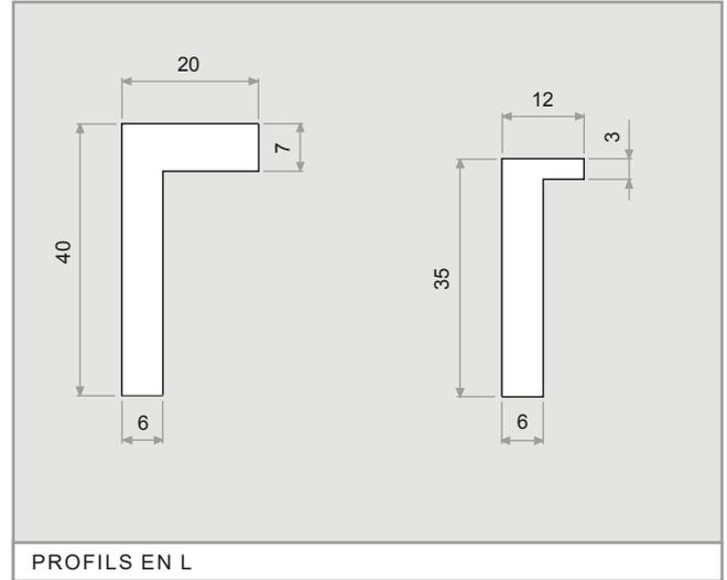
Pour réaliser le support et glissement du tapis, EUROBELT a créé deux types de profils de support avec différentes géométries, mais avec d'identiques fonctions et prestations.
