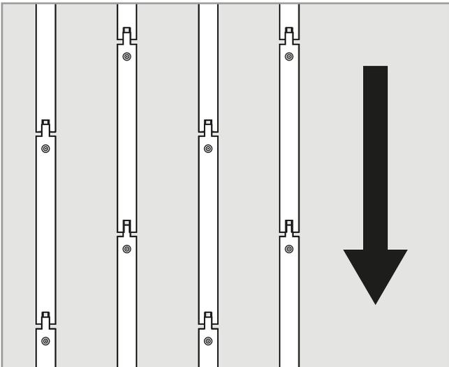
Il consiste à placer les bandes de glissement en parallèle et continu sur la structure du convoyeur tout le long de celui-ci.
