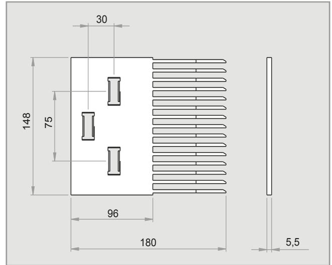
Les peignes de transfert ont été dessinés pour être utilisés avec la surface Raised Rib dans des applications de jonction de lignes où il est nécessaire de réaliser le transfert du produit au moyen du système de transfert avec des peignes.
